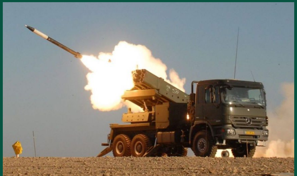
Azerbeidzjan ontplooipte het Israëlische EXTRA (EXTended Range Artillery) raketsysteem met een bereik van 150 km en een precisie van 10 m.
